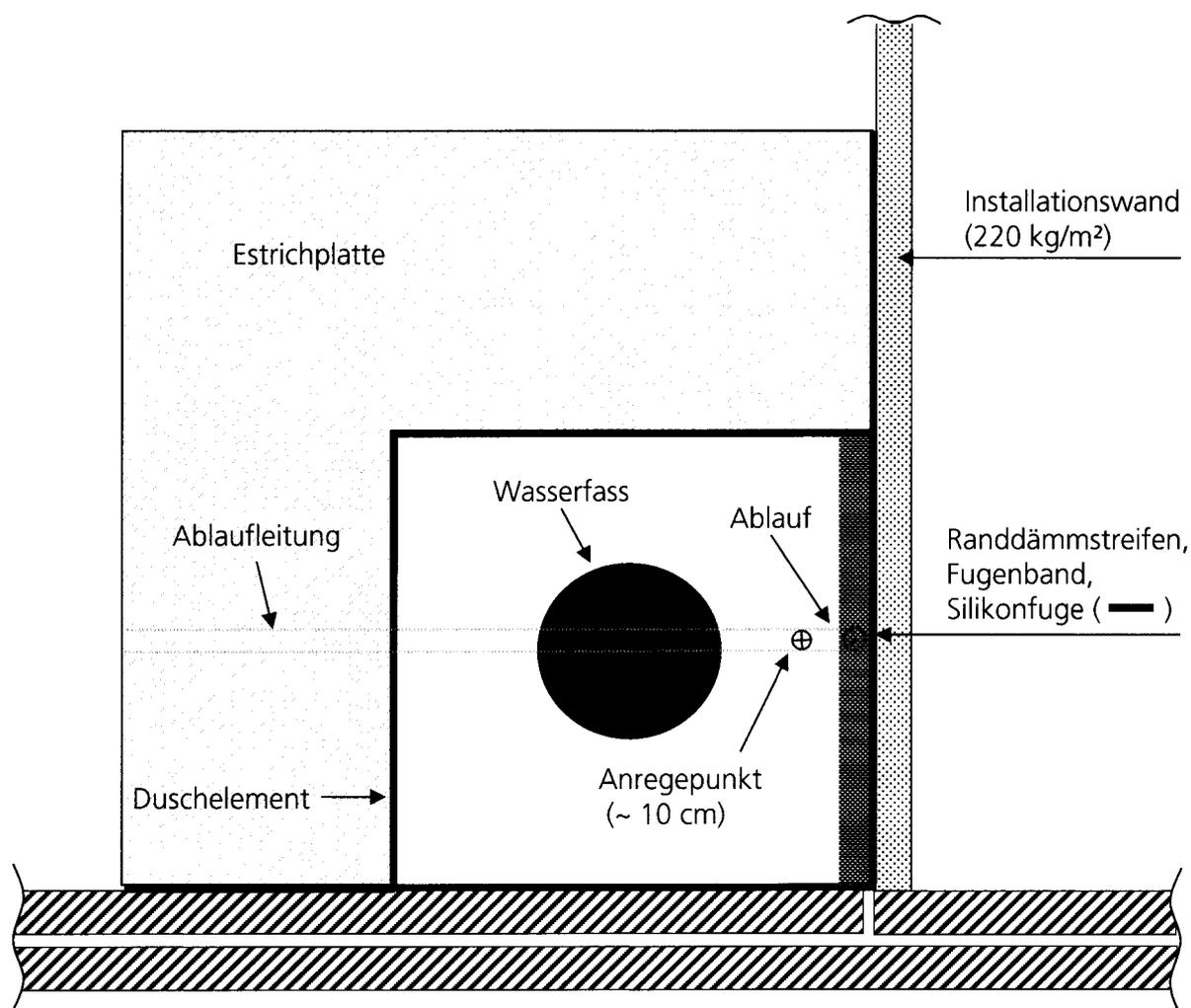
Lage des Prüfaufbaus im Installationsraum (EG vorne).
