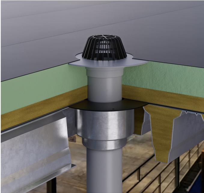
Besonderes Augenmerk ist dabei auf Durchdringungen wie z. B. Dachabläufe zu richten, um eine Brandausbreitung über das Dach zu verhindern. Speziell für diese Dachaufbauten gibt es das Brandschutzelement Stahltrapez 12, das in der Stahltrapezkonstruktion hängt. So können die Dämmstoffe an das Ablaufgehäuse anschließen. Die Funktionselemente in Anlehnung an abZ-Nr. 2-19.17-1800 enthalten einen Quellstoff, der im Brandfall die Dachdurchführung verschließt und zuverlässig nach unten abschottet.
